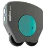
Das Gerät wird per Bluetooth an den Rechner angeschlossen und muss in der Software erstangebunden werden. Folgen Sie im weiteren Verlauf den Anweisungen aus dem entsprechenden Benutzerhandbuch.
